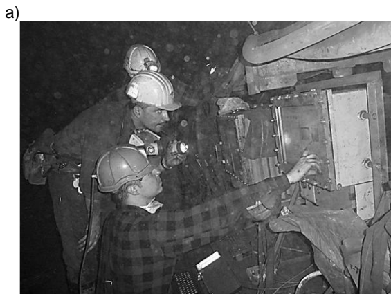
Rys. 2. Stacja robocza KOMAG, na której zainstalowano System Diagnostyki, Identyfikacji Elementów Maszyny i Obserwacji Warunków Pracy (a), interfejs użytkownika warstwy programowej systemu (b) (źródło: [2])
